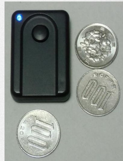
専用充電式超小型インバータ (Li-ポリマー バッテリー内蔵)
